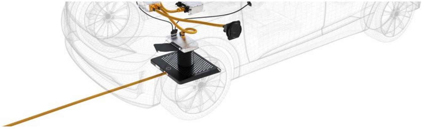
Bei der Matrix Charging Technologie wird die Energie durch die direkte physische Verbindung der leitenden Kontakte übertragen.
